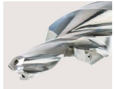
La correcta ubicación de las salidas de refrigerante en el mecanizado con lubricación minimizada (MQL) es decisiva para el rendimiento de la broca. El aerosol debe llegar a los lugares donde se necesita para la lubricación. De este modo, por ejemplo, se reduce el riesgo de recrecimiento de los filos y, naturalmente, también se prolonga la duración de la broca.
