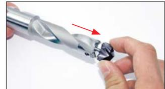
3. Extraiga el cabezal de taladrado del dentado.
