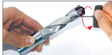
2. Abra el tornillo de sujeción utilizando la llave para tornillos de cabeza hexagonal suministrada.
