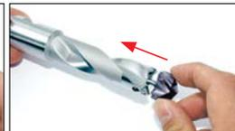
2. Coloque el nuevo cabezal de taladrado en el soporte.
