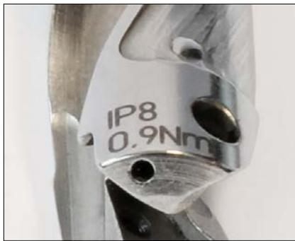
5. Apriete el tornillo de sujeción especial con el par de apriete especificado.
