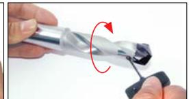
3. Apriete el tornillo de sujeción manualmente en sentido horario.
