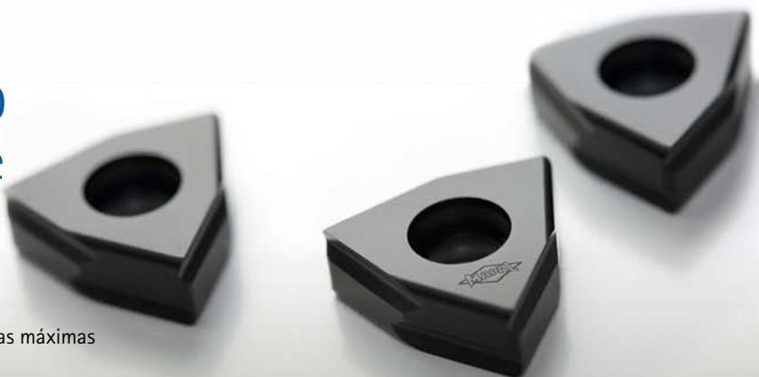
MAPAL ha desarrollado una serie de materiales de corte con revestimiento de CVD, especialmente adaptada a los requisitos del retaladrado de todos los materiales de fundición GJL, GJV y GJS. Los nuevos materiales de corte HC720, HC725, HC730 y HC735 se diferencian por el sustrato de metal duro utilizado. Los cuatro convencen por el revestimiento de óxido de aluminio  $\alpha$  extremadamente resistente al calor, con
