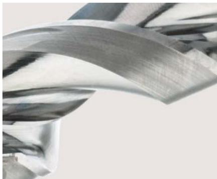
Las ranuras de alojamiento de virutas están pulidas con alto brillo, de modo que se reduce la fricción de las virutas y, consecuentemente, también disminuye la entrada de calor en la pieza. La ejecución en espiral de las ranuras de alojamiento de virutas permite una evacuación «mecánica» de las virutas. Los ángulos de desprendimiento muy positivos reducen las fuerzas de corte necesarias.
