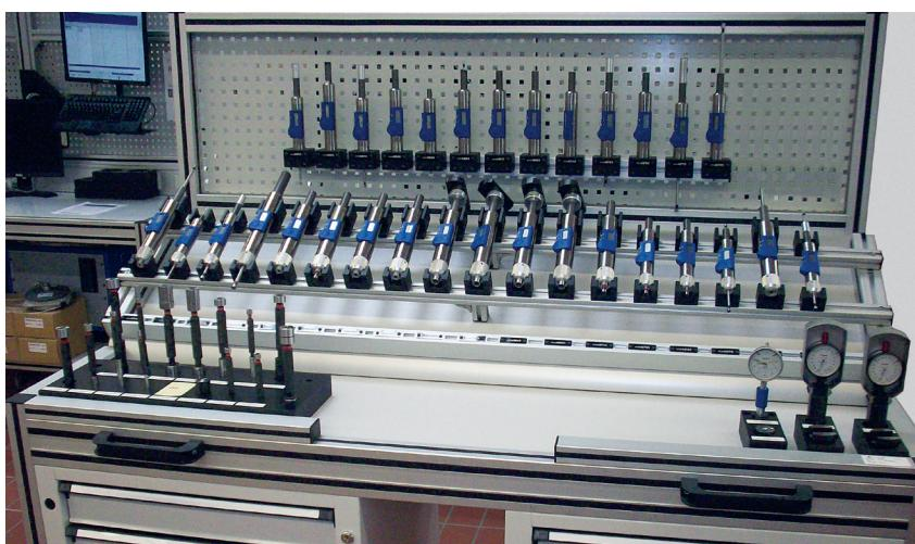
Messstation ausgestattet mit MultiCheck (z.B. in einer Motorenfertigung)
