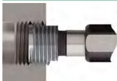
Die Gewindestecklehre bleibt zwischen den beiden Absätzen stehen. Das Werkstückgewinde ist in Ordnung.
