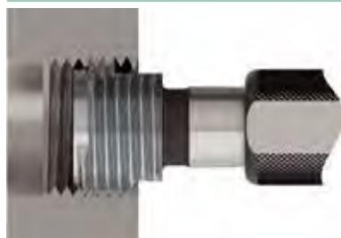
Die Gewindestecklehre lässt sich bis zum Größtmaß-Absatz ein- bzw. aufschrauben. Das Werkstückgewinde ist am Größtmaß.
