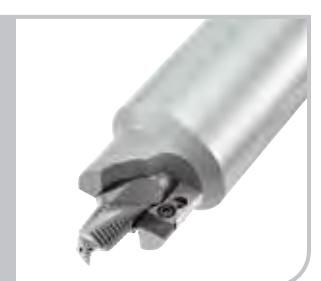
Kombinationswerkzeug mit Bohrgewindefräser M 16 x 1,5 stirnschneidend und einer PKD bestückten Konturplatte zur Bearbeitung einer vorgegossenen Bohrung
