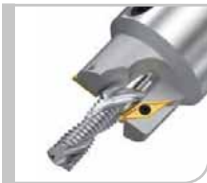
Kombinationswerkzeug mit Bohrgewindefräser M 12 2,5xD, IK Plansenk- und Anfasplatte
